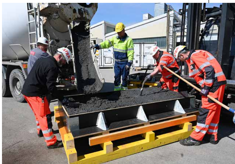
In Sommer- und Winterversuchen wurde klimafreundlicher Beton untersucht. © Doka
